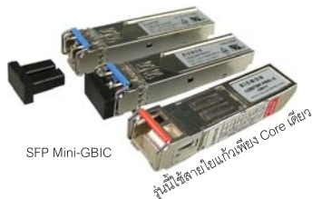
ตัวอย่าง : Converter SFP Slot & Switch จะมีช่องใส่ SFP Mini-GBIC ได้ตั้งแต่ระยะทางที่ 550 ม. - 120 กิโลเมตร
